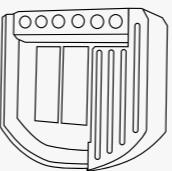
El Smart Drive permite convertir cualquier cortina motorizada de Bandalux en un dispositivo inteligente. Este pequeño aparato se integra en el motor de la cortina permitiendo ampliar el alcance de LYNX.
